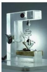
*Первый полупроводниковый триод, созданный в США*
