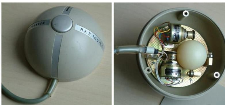
Рис. 4. Модель Rollkugel фирмы Telefunken, 1968 г.
