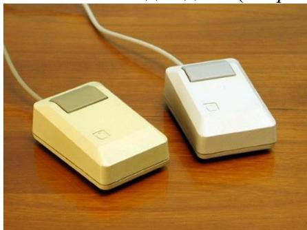
Рис. 12. Однокнопочная мышь фирмы Apple
