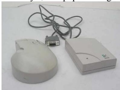
Рис. 16. Первая беспроводная мышь фирмы Logitech
