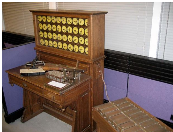
Табулятор Холлерита. Ящик справа — картридер. Фото: Wikimedia Commons
