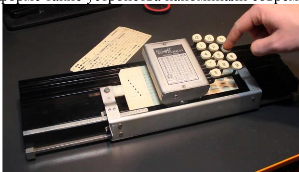
Ручной перфоратор Wright Punch. Кадр: Nevlabs / YouTube
