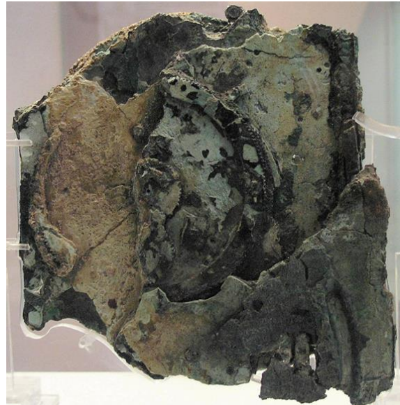
Антикитерский механизм (Фрагмент А — сзади). Источник Wikipedia
