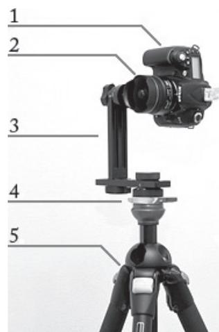
*Рис. 1. Набор оборудования для съемки 3D: 1 — фотоаппарат, 2 — объектив, 3 — панорамная головка, 4 — уровневая платформа, 5 — штатив*
